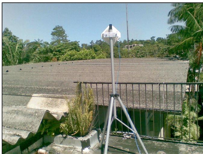
**Figura 5.2: Antena Wi-Max SS utilizada no testbed.**
