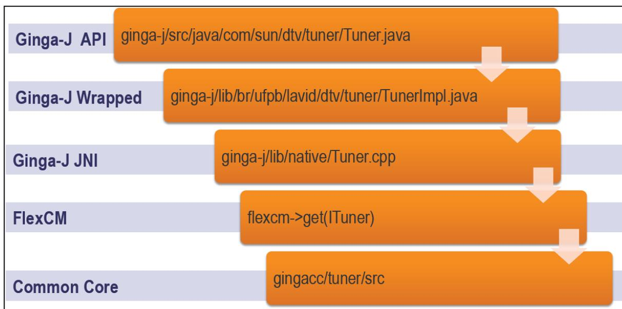
Figura 3.4: Pilha de camadas do componente Tuner (LAVID, 2011).
