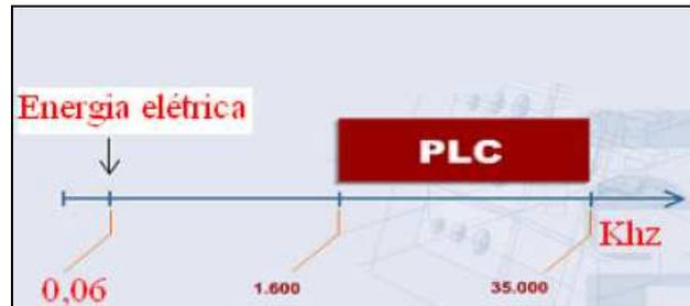
Figura 2.6: Espectro de frequências do PLC
