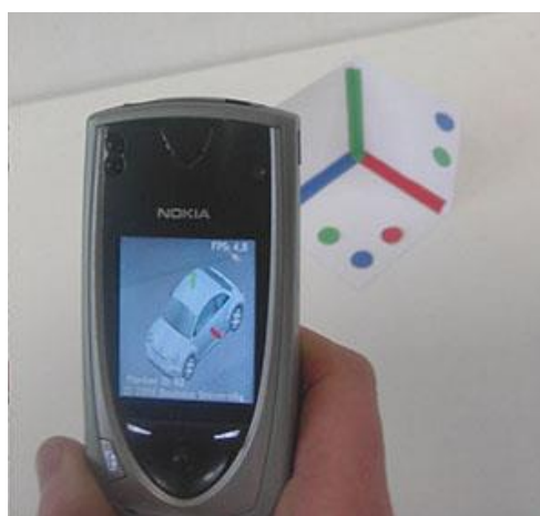
Figura 38: Celular identificando marcadores e inserindo objeto virtual na cena real. (Möhring, Lessig, & Bimber, 2004).
