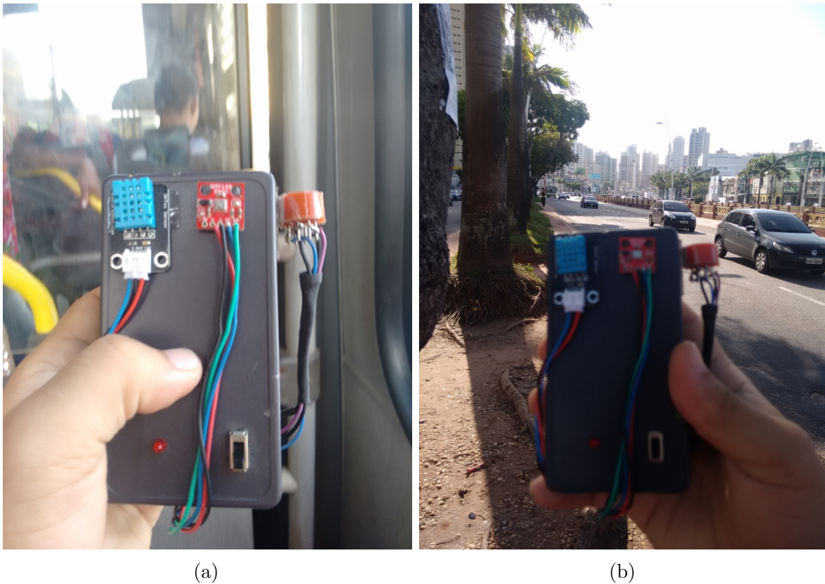
Figura 19 – Protótipo de computação vestível onde (a) é coleta dentro de ônibus próximo à janela e (b) coleta a pé. Em ambos os casos o protótipo foi carregado na altura do peito do usuário.
