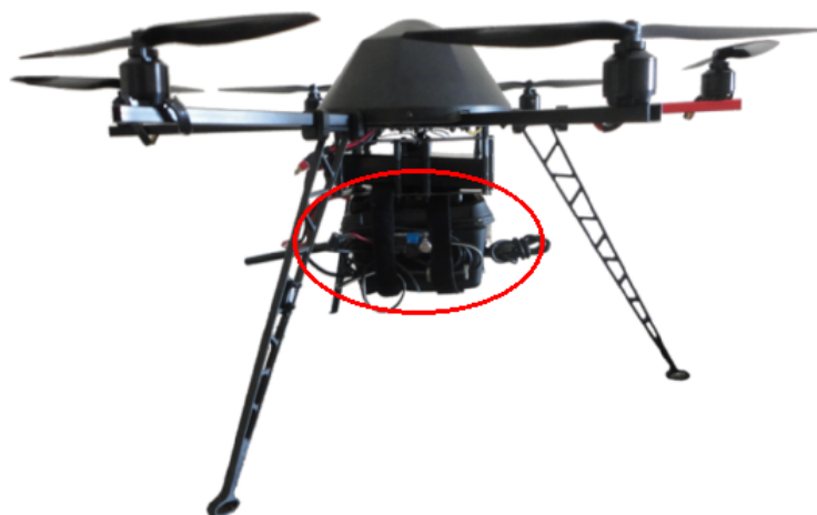
Figura 14 – MikroKopter Hexa, usado no trabalho de Vieira (2015), este equipado com o módulo UAV Brain destacado entre os trens de pouso.
