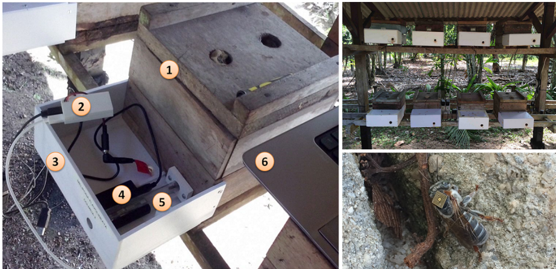
Figura 13 – Esquerda: (1) Colmeia da abelha Melipona fasciculata , (2) Intel Edison para controle do RFID e armazenamento de dados, (3) caixa de PVC para armazenamento dos itens eletrônicos, (4) leitor de antena RFID, (5) tudo plástico para a passagem das abelhas. Topo à direita: Visão geral das 8 colmeias. Inferior à direita: Abelha com etiqueta RFID anexada ao tórax.
