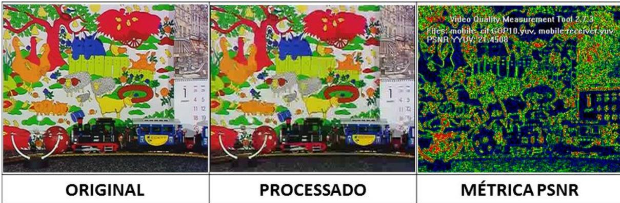
**Figura 5.2:** Resultado do processamento do vídeo enviado e recebido para a métrica PSNR
