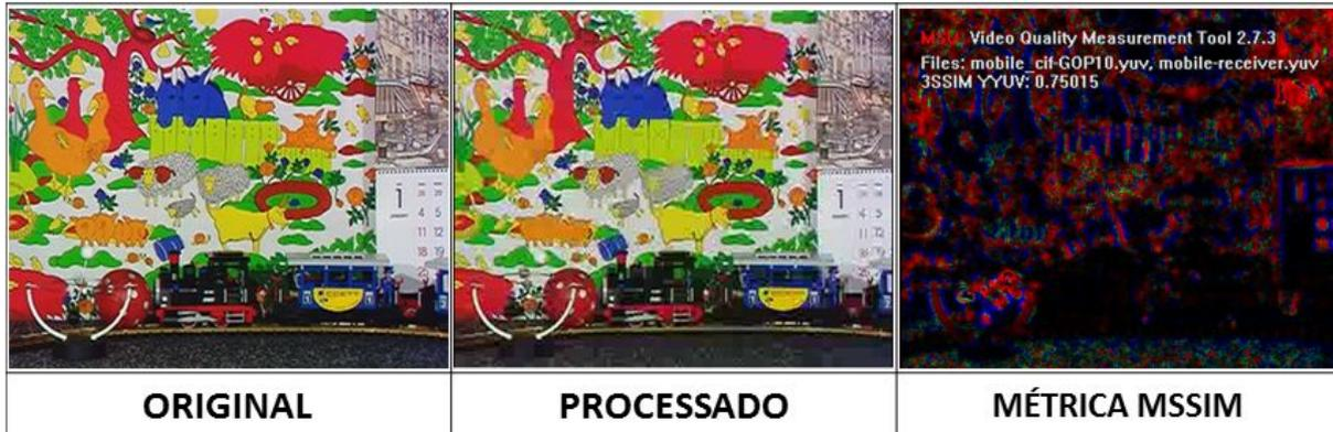
**Figura 5.5:** Resultado do processamento do Vídeo enviado e recebido para a métrica MSSIM
