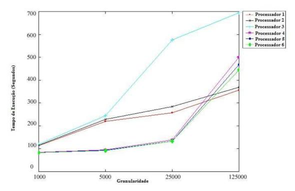
Figura 18 - Desempenho do Algoritmo quanto à granularidade.
