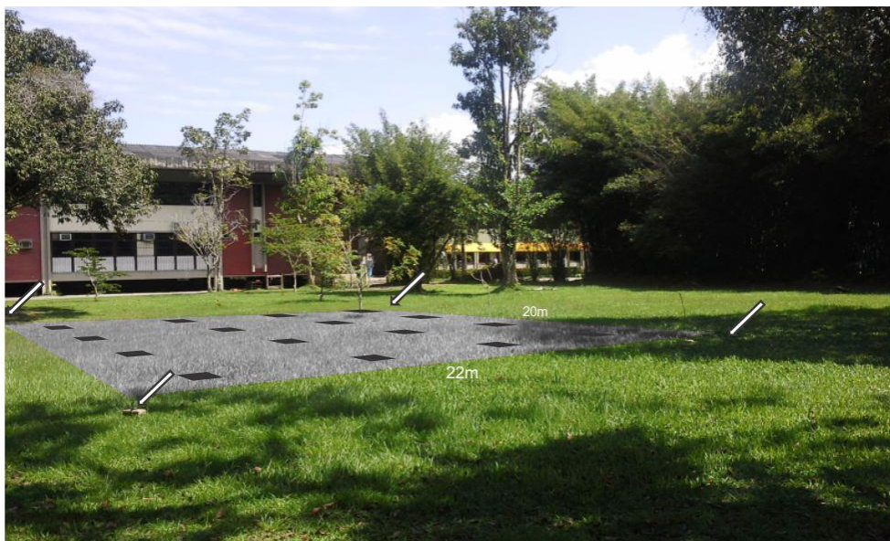
Figura 4.8: Setas brancas indicam a posição dos âncoras. Pontos pretos ilustram as 16 posições onde o alvo foi posicionado para testes.
